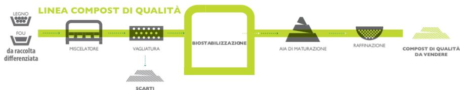
I rifiuti organici vengono portati all'impianto di Compostaggio di Pietramelina dove, dopo una fase di miscelazione e vagliatura, subiscono un trattamento di biostabilizzazione. Una volta stabilizzato il materiale passa in una aia di maturazione ed infine passa all'ultima fase di raffinazione. A questo punto il compost è pronto per essere imbustato in due versioni, in polvere o pellettato, con il nome di **Composta**.
